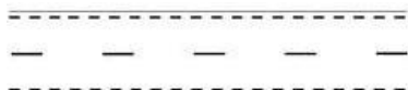
Marcaj de separare a sensurilor de circulație format dintr-o linie discontinuă simplă. Marcaj de delimitare a părții carosabile cu linie discontinuă
